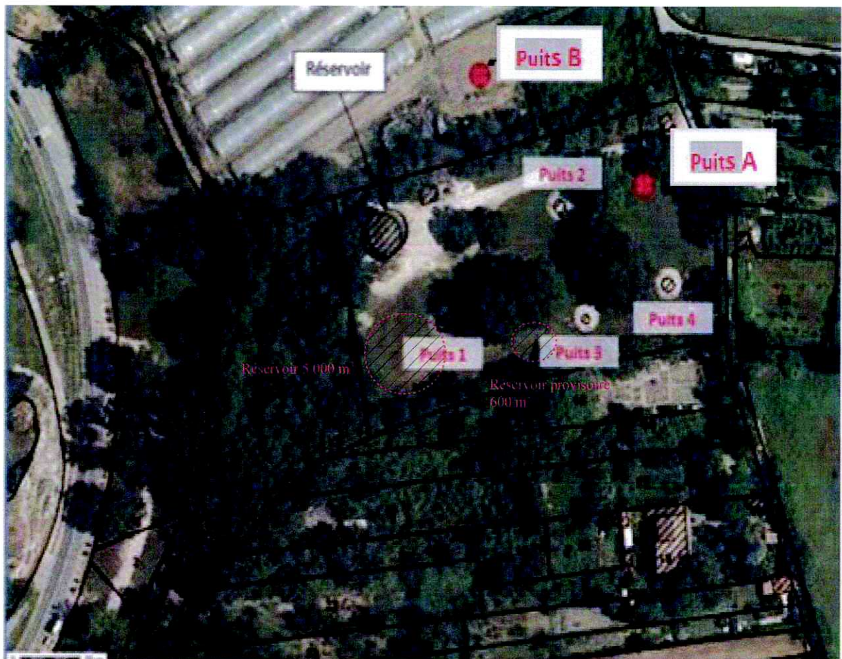
Figure 2 : localisation des emplacements envisagés pour l'implantation d'un nouveau puits (emplacement envisagé noté Puits A et Puits B, les puits 1, 2, 3 et 4 sont les puits existants) et des réservoirs définitif et provisoire envisagés
